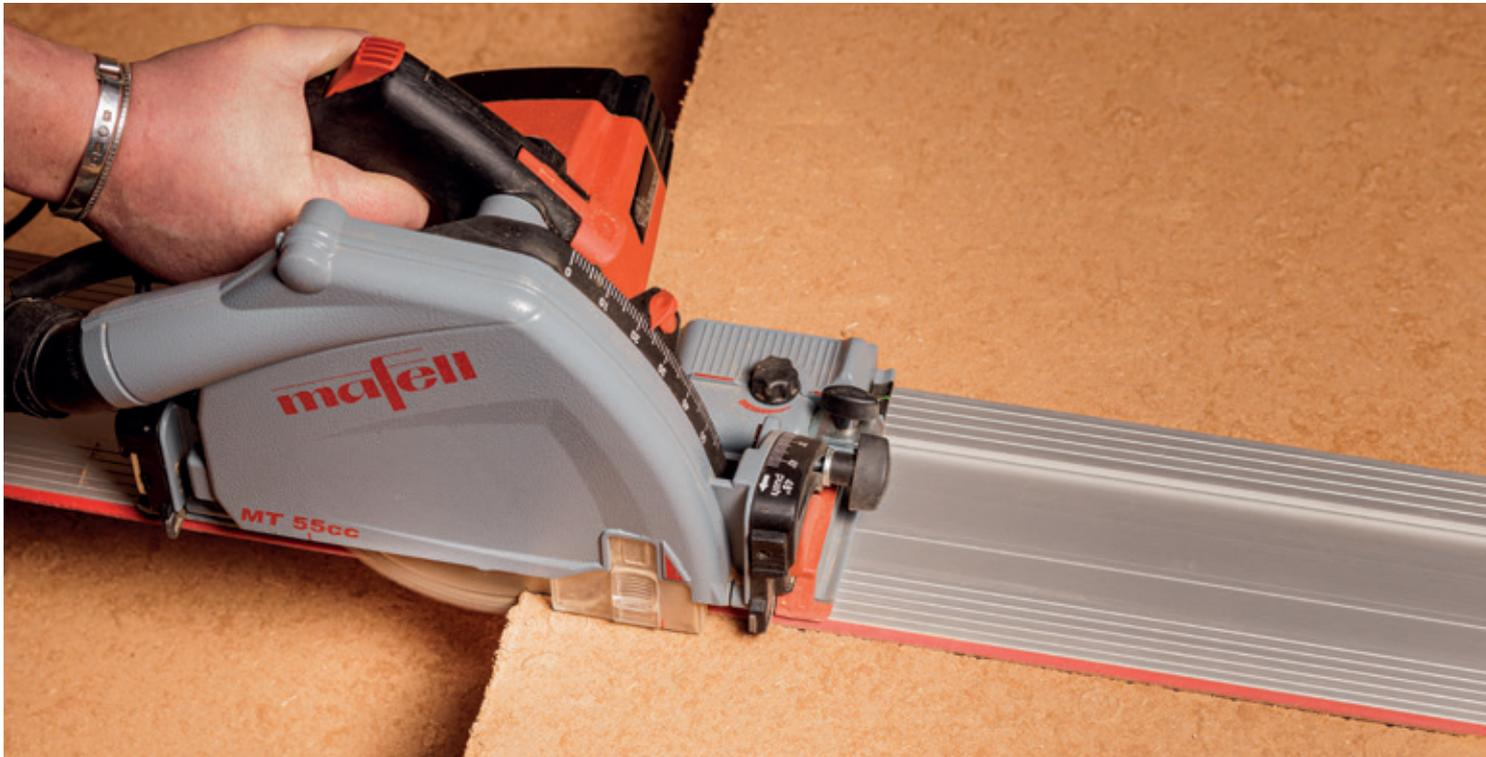
Am einfachsten geht das mit einer Tauchsäge und passender Führungsschiene (z.B. Mafell MT55).
